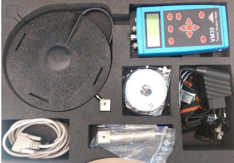
Slika 7: Uređaj za mjerenje razine traktorski vibracija koje djeluju na trup rukovatelja (vlastita fotografija)
