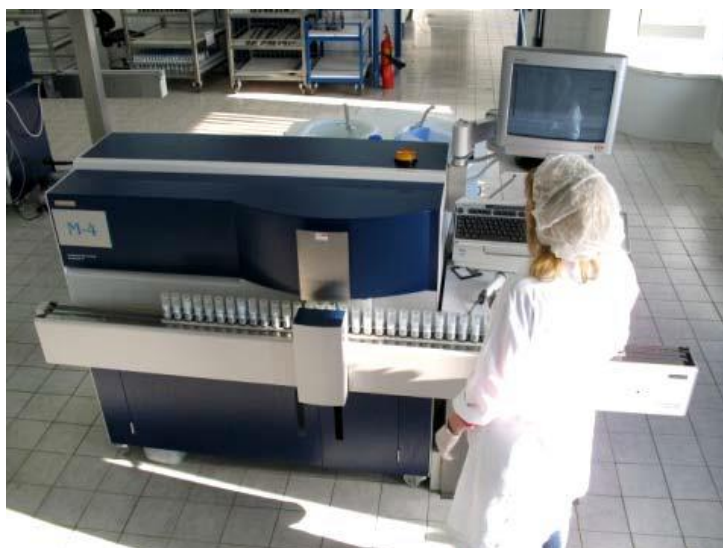
Slika 13. Analiza mlijeka epifluorescentnom protočnom citometrijom
