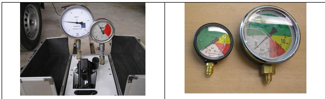
Slika 12. Ispitivanje ispravnosti rada najčešće ugrađenih manometara na raspršivačima
