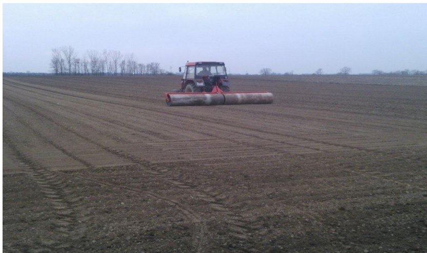
Slika 8: Valjanje poslije sjetve (Izvor: M. Mihaljević)
