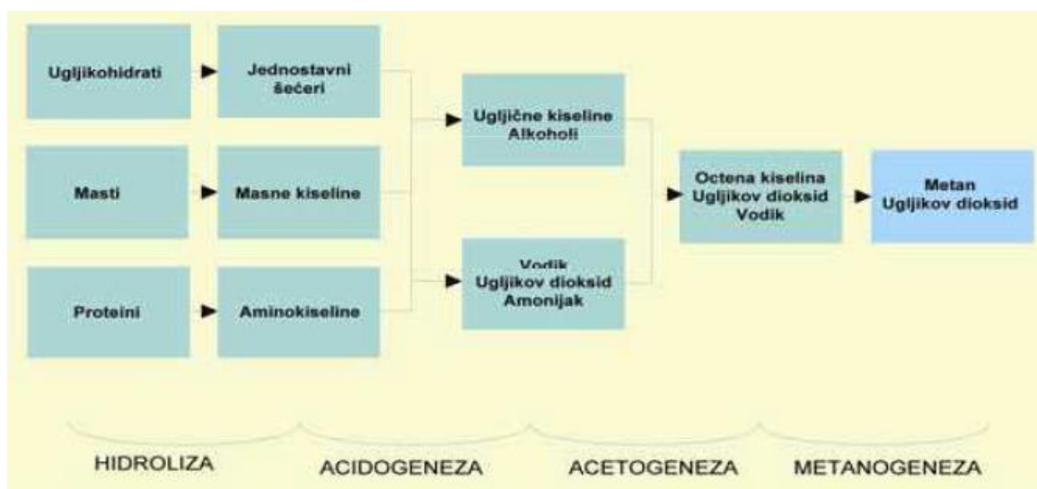
Slika 7. Shematski prikaz četiri glavne faze anaerobne digestije
