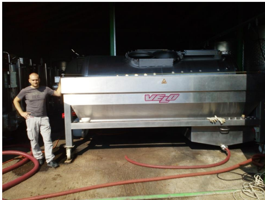
Slika 8. Pneumatska preša zapremine 5 270 l u vinariji Josić
