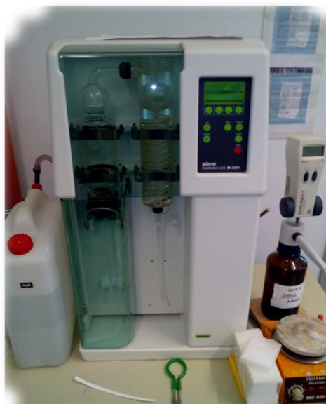
Slika 32 Automatizirana Kjeldahl analiza
