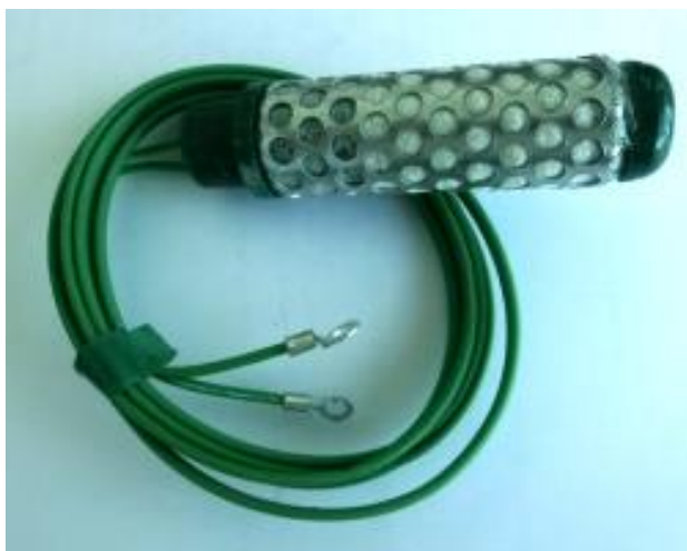
Slika 9. Granular matrix senzor (Foto: M. Marković)
