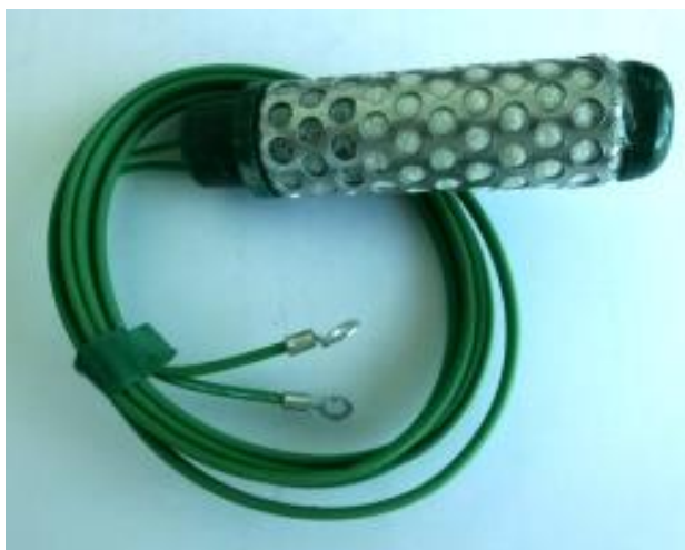
Slika 9. Granular matrix senzor (Foto: M. Marković)
