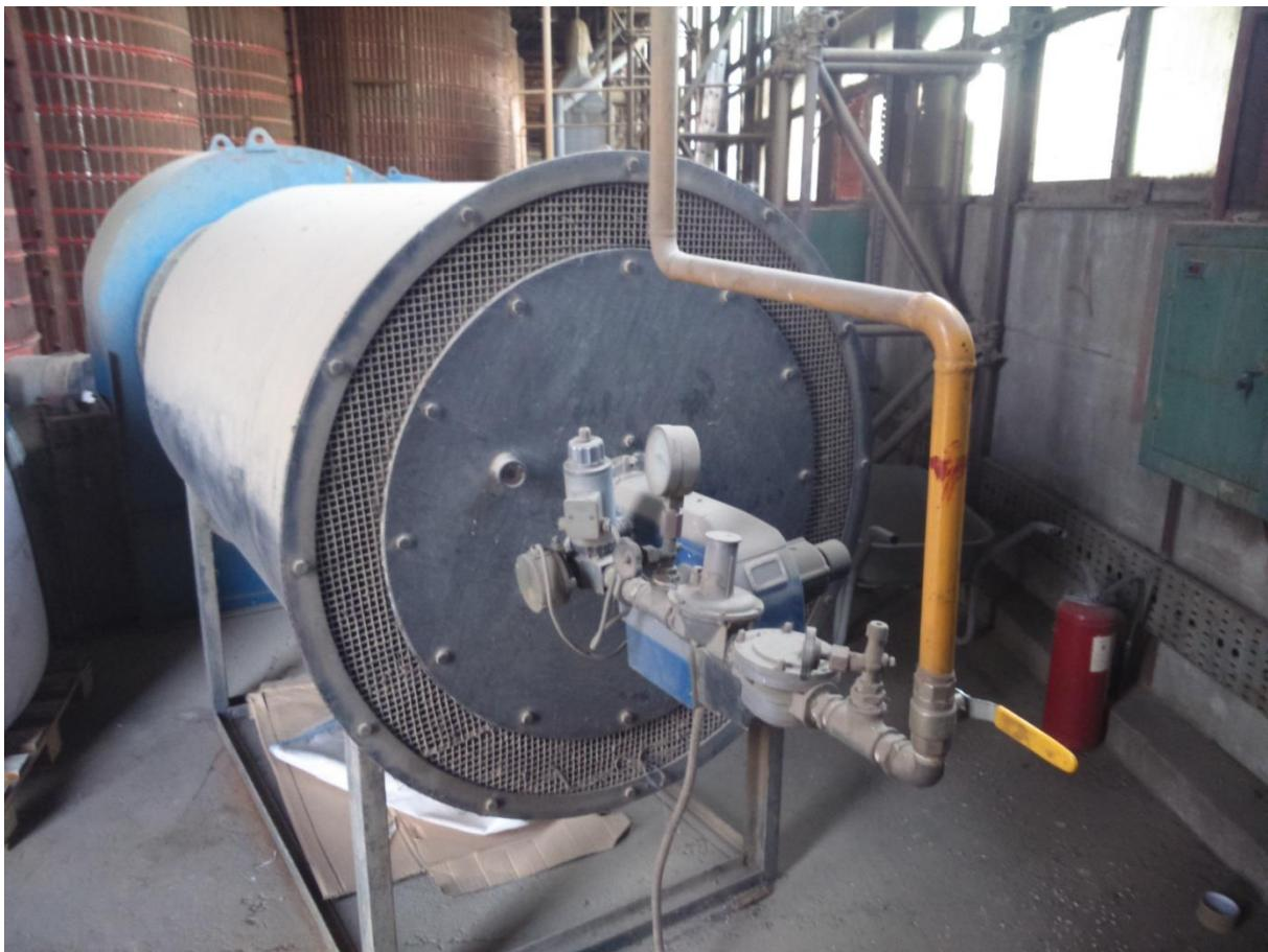
Slika 15. Plinska peć za zagrijavanje zraka (vlastita fotografija)
