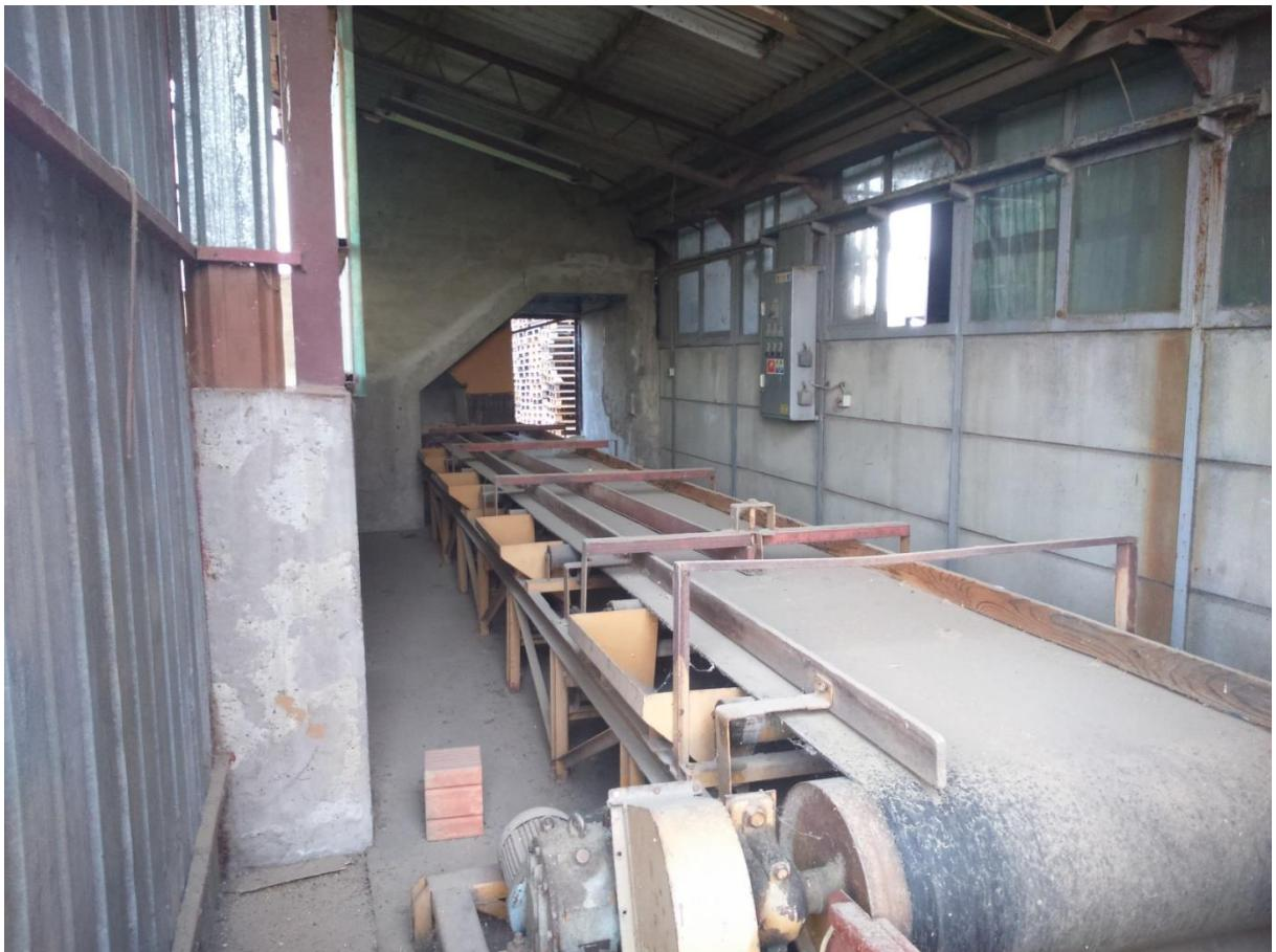
Slika 4. Transportna traka do elevatora (vlastita fotografija)
