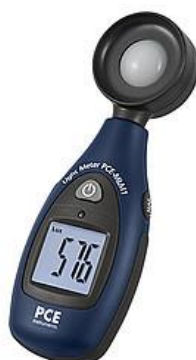
Slika 8. Uređaj za mjerenje osvjetljenosti objekta (Izvor: www.amt-metriks.ba )
