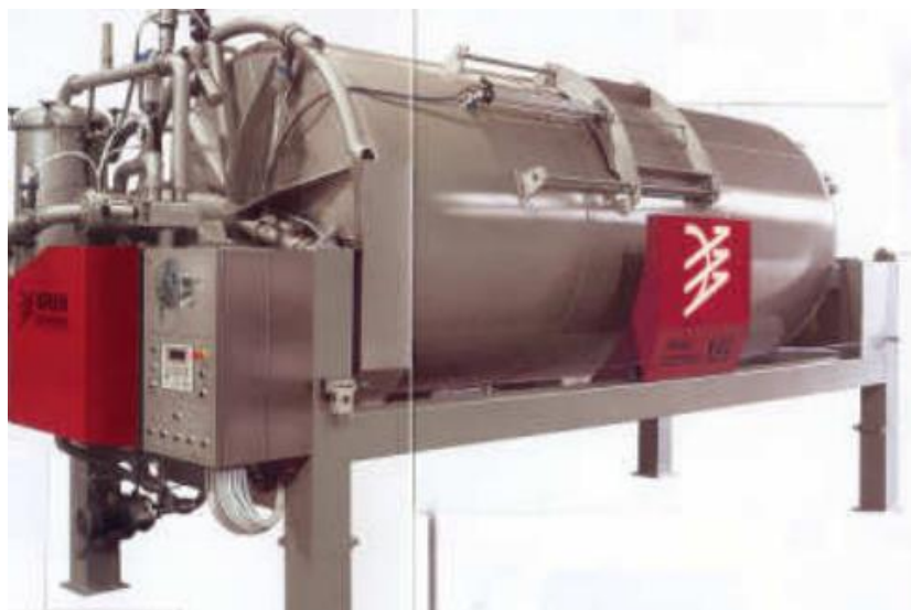
Slika 5. Vakuumpreša, Izvor: Vinarstvo I [skripta]. Poreč, (2006): Veleučilište u Rijeci, stručni studij vinarstva
