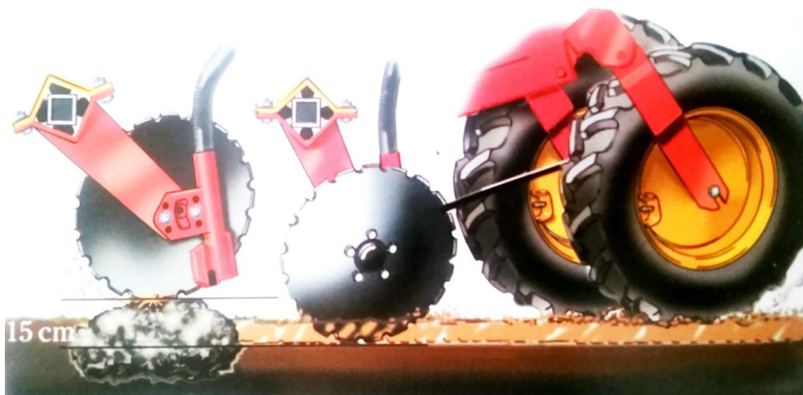
Slika 11: Otpornost na udarac kamena
