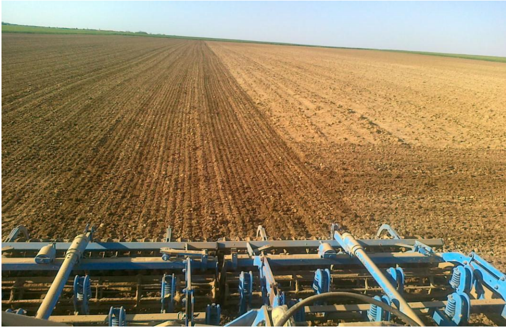
Slika 6. Predsjetvena priprema tla – sjetvospremač Lemken kompaktor (Izvor: Bromus d.o.o.)
