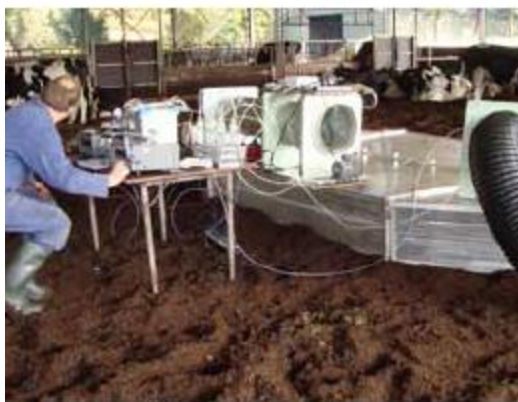
Slika13. Mjerenje emisije amonijaka s dinamičkom kutijom (Galama i sur., 2011)
