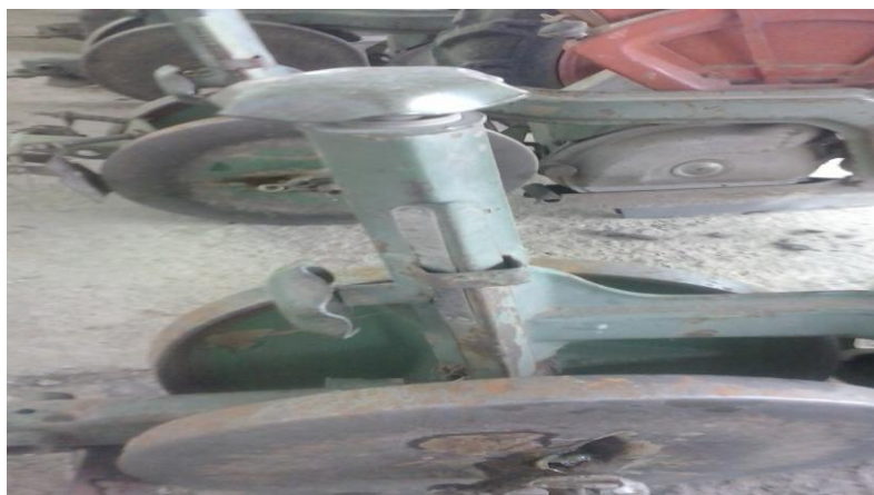
Slika 16. Ručica za podešavanje dubine sjetve.
