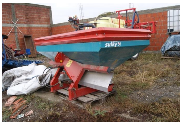
Slika 7. Rasipač mineralnog gnojiva „Sulky burel“ (Foto: Marijana Tadić)
