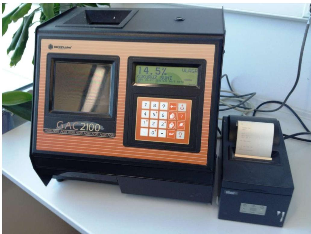
Slika 2. Uređaj za mjerjenje vlage, temperature i hektolitarske mase zrna s pisačem
