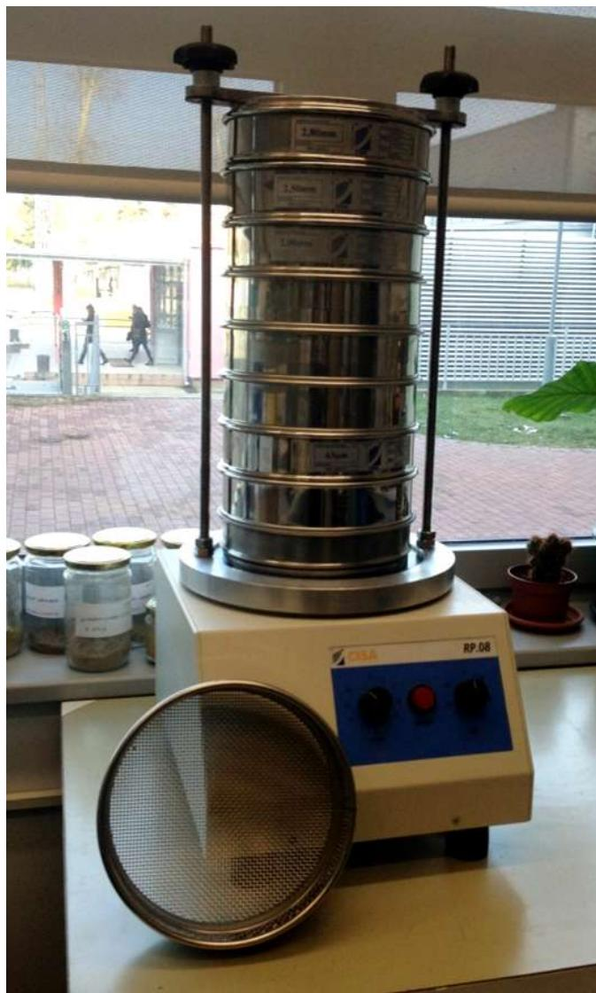
Slika 3. Elektromagnetska tresilica za prosijavanje CISA RP08 ø200/203
