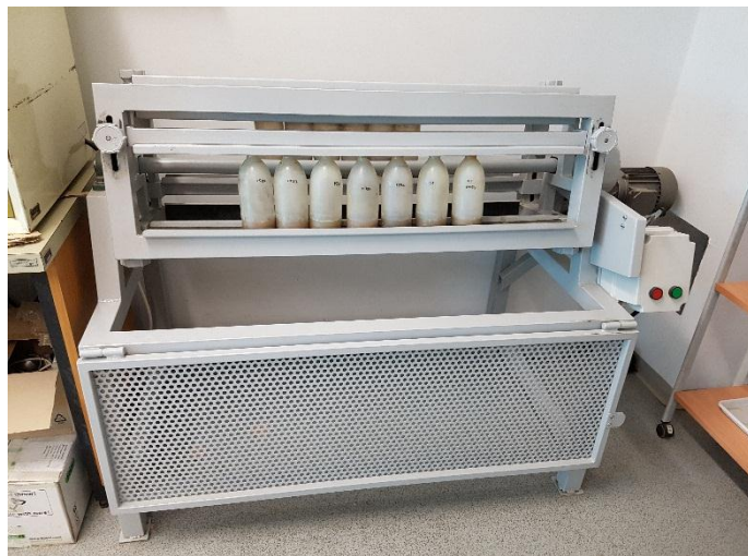
Slika 6. Mućkanje suspenzije tla na rotacijskoj mućkalici
