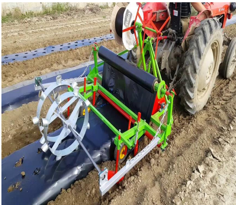
Slika 5. Strojno postavljanje crne polietilenske folije
