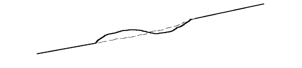
Slika 13. Terasa za zaustavljanje otjecanja
