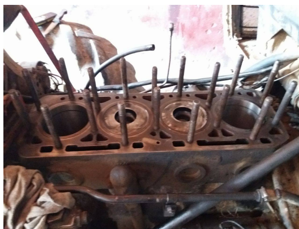
Slika 12. Skidanje glave motora i košuljica cilindara (Izvor: Vlastita fotografija)
