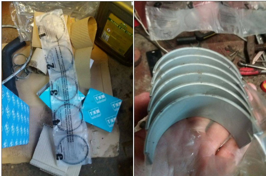
Slika 14. Novi leteći ležaji i klipni prsteni (izvor: Vlastita fotografija)
