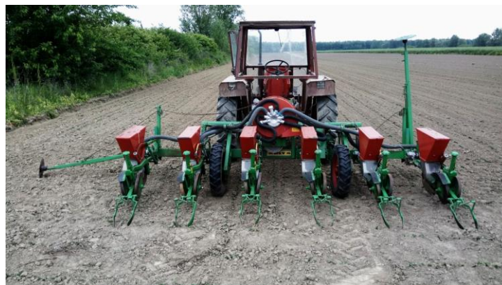
Slika 12. Sjetva suncokreta s pneumatskom sijačicom OLT (izvor: Vidaković, T.)
