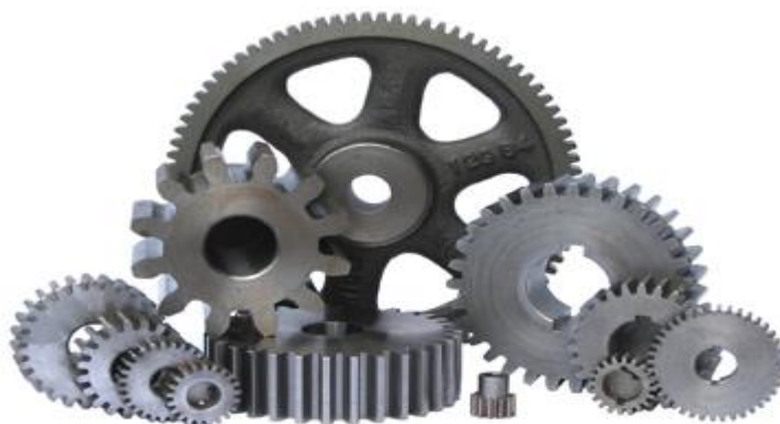
Slika 15. Zupčanici napravljeni lijevanjem sivog lijeva u kalupe
