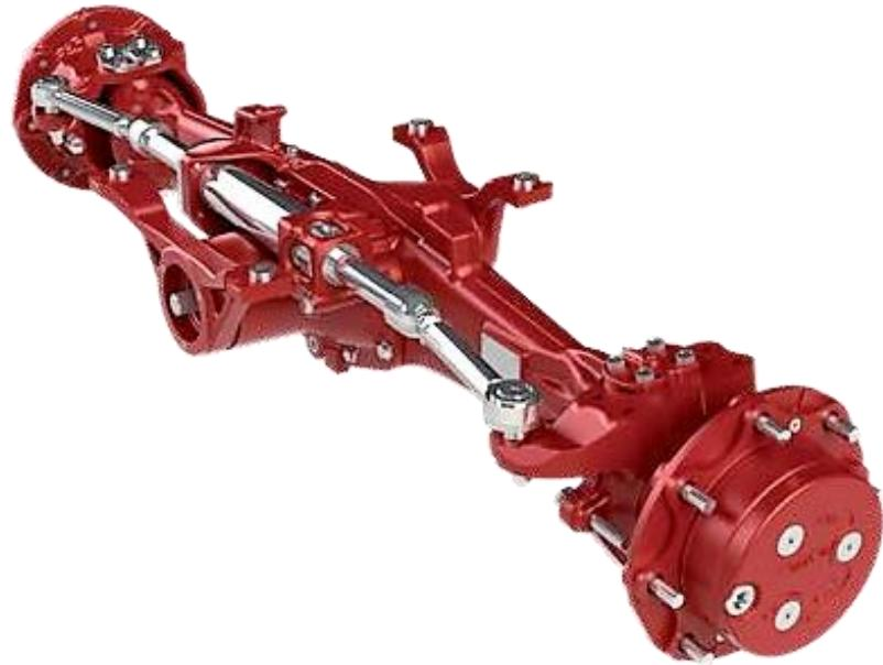
Slika 13. Spoj prednjih poluvratila diferencijalom s ograničenim proklizavanjem (Izvor:
