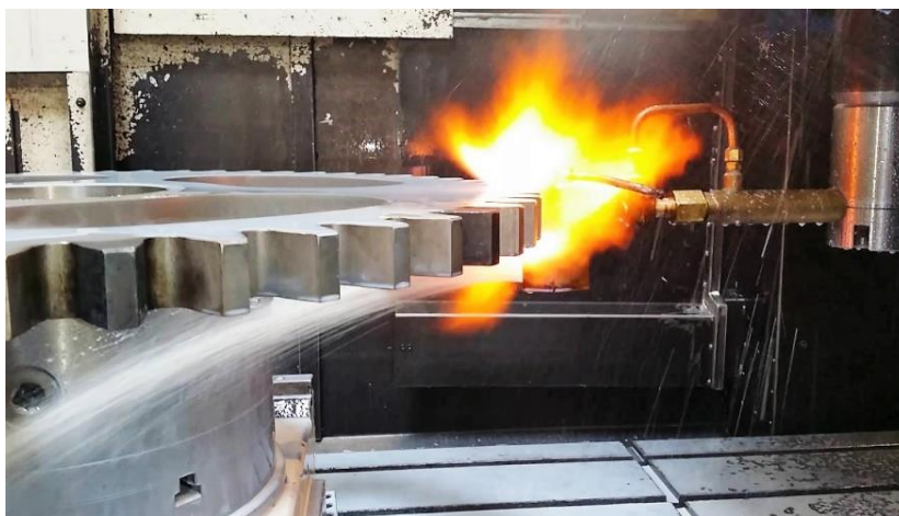
Slika 36. Plameno zagrijavanje zupčanika
