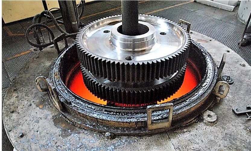
Slika 33. Zagrijavanje zupčanika u plinskim pećima
