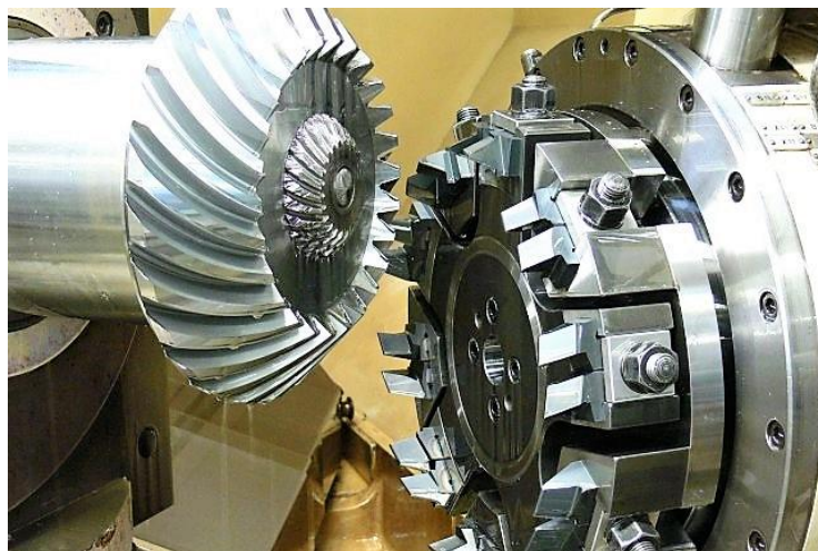
Slika 25. Glodanje zupčanika Klingelberg metodom (Izvor: https://www.tandler.de/unternehmen/fertigung-maschinenpark/kegelradverzahnen/ )
