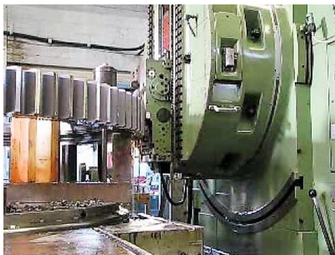
Slika 30. Izrada cilindričnih zupčanika Maag metodom
