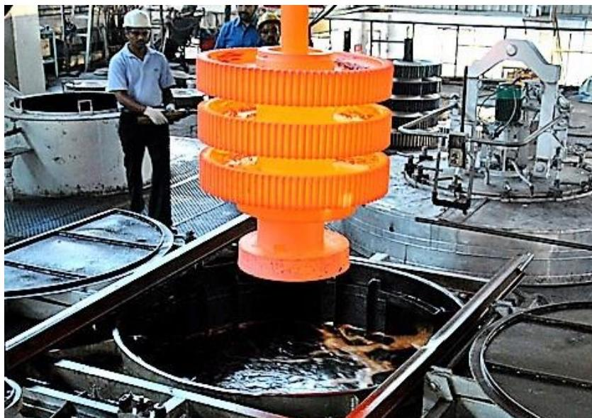
Slika 34. Kaljenje zupčanika u uljnoj kupci
