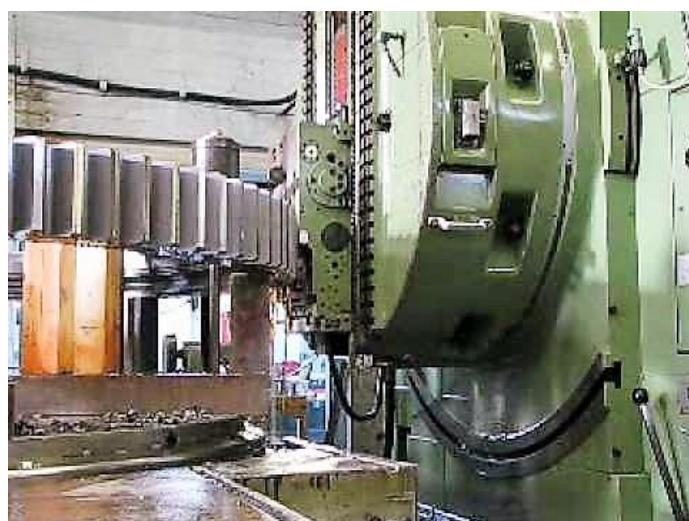
Slika 30. Izrada cilindričnih zupčanika Maag metodom
