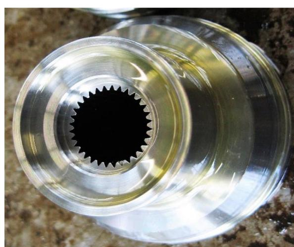
Slika 32. Unutarnje ozubljenje izrađeno provlačenjem (Izvor: <https://upload.wikimedia.org/wikipedia/commons/d/d3/Ger%C3%A4umte-Kerbverzahnung2.JPG>)
