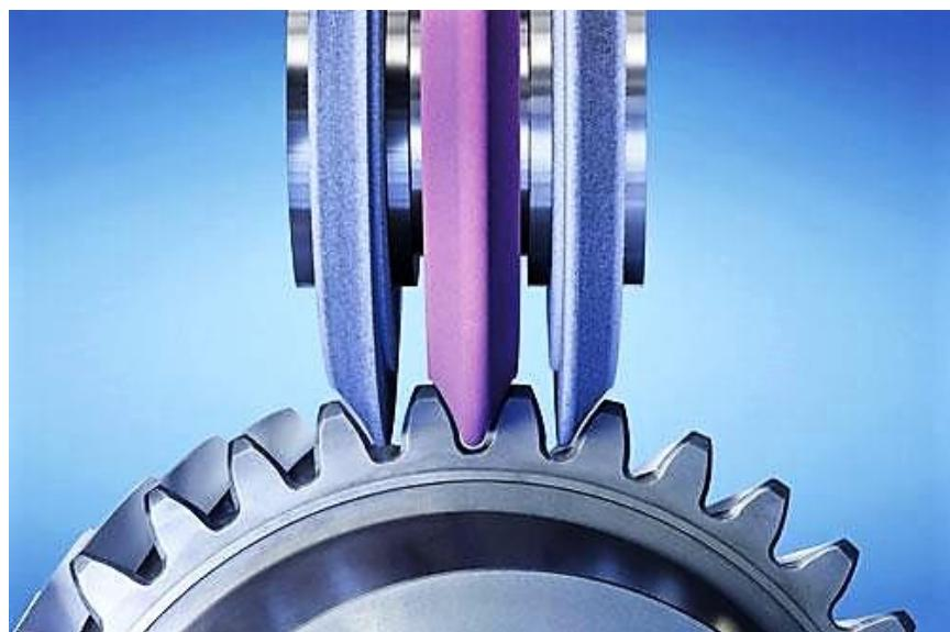
Slika 37. Brušenje zupčanika
