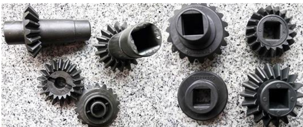
Slika 18. Zupčanici sijačice „Gaspardo“ (Izvor: https://www.agroklub.com/poljoprivredni-oglasnik/oglas/zupcanici-gaspardo-sijacice-g20860126r/33694/ )
