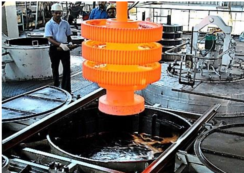
Slika 34. Kaljenje zupčanika u uljnoj kupci
