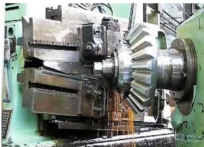
Slika 30. Izrada konusnih zupčanika Oerlikon metodom
