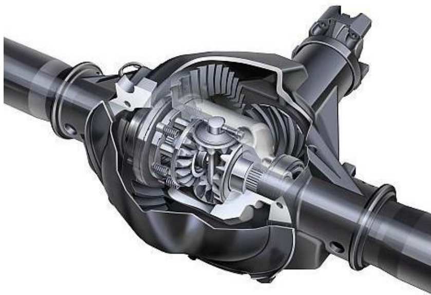
Slika 14. Diferencijal s mogućnošću zaključavanja
