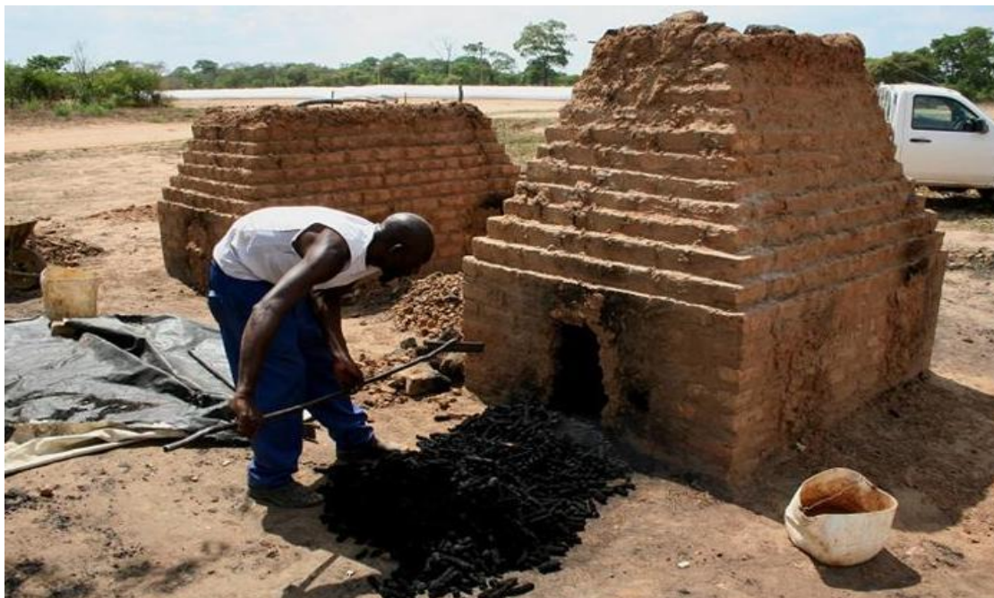
Slika 6. Peć od cigala sagrađena za proizvodnju biougljena
