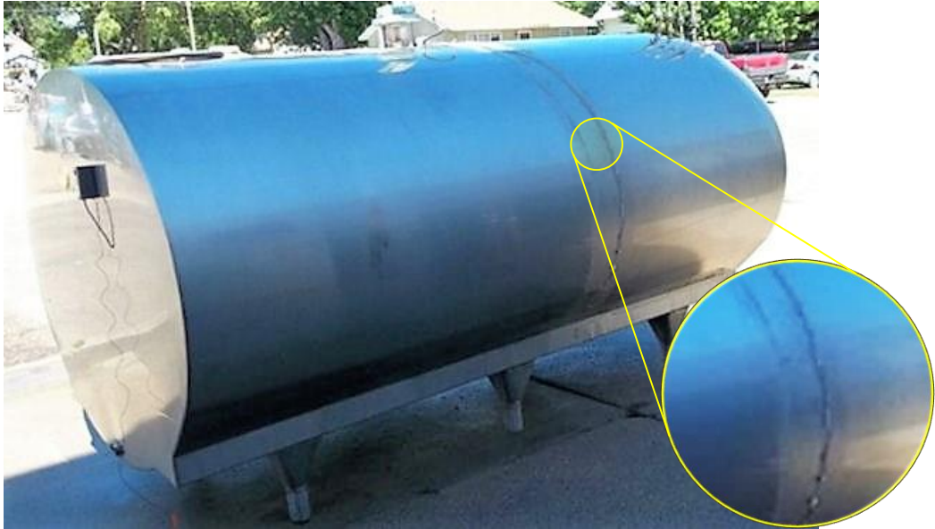
Slika 23. Reparaturno zavarivanje spremnika za mlijeko (Izvor: http://www.schiercompany.com/FarmTanks.html )
