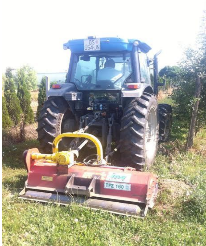
Slika 7. Malčer VOGER model TFZ 160 (vlastita fotografija)
