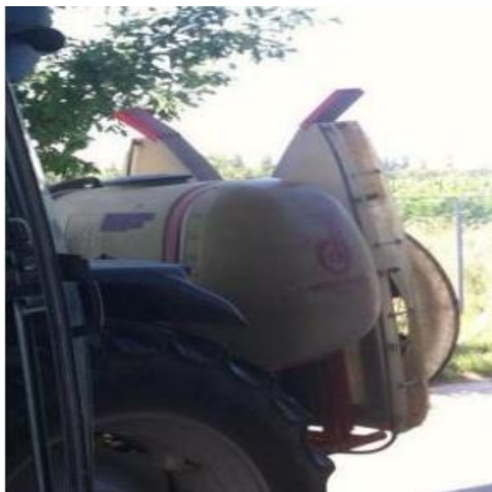
Slika 6. Nošeni traktorski raspršivač Agromehanika AGP 250 (vlastita fotografija)
