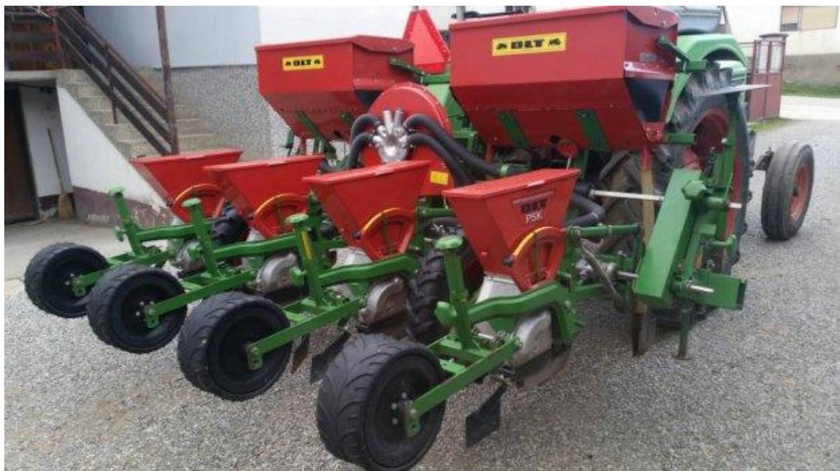
Slika 6: OLT PSK sijačica (Izvor: <http://www.njuskalo.hr/image-bigger/strojevi-sjetva-zetva-berba/olt-psk-4-reda-slika-64604017.jpg> )
