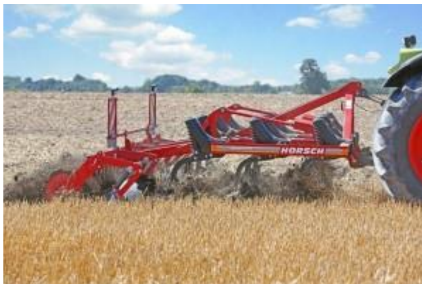
Slika 8. Površinska obrada strništa gruberom (Izvor: http://www.agroklub.com/ )
