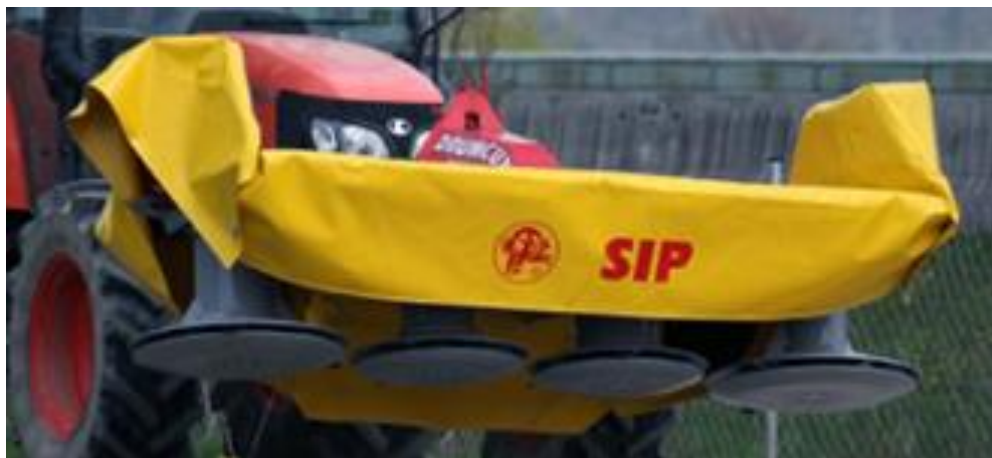
Slika 6. Širokozahvatna rotirajuća travokosilica s bubnjem " SIP DRUM 275 F" (Izvor: link 4.)
