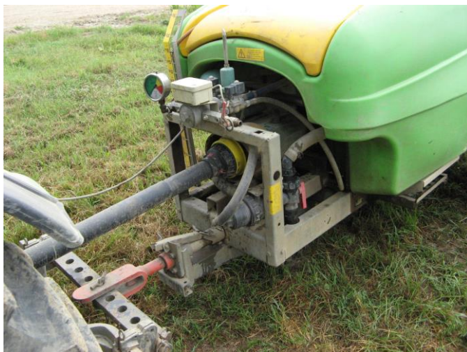
Slika 1. Pravilno postavljena zaštita priključnog vratila
