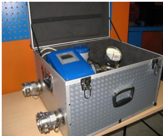
Slika 6. Elektromagnetski mjerač kapaciteta crpke tvrtke Krohne
