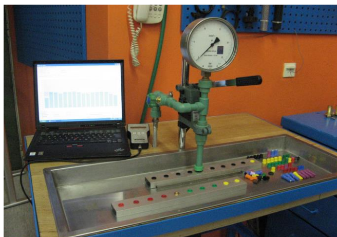
Slika 8. Stolno – elektronski uređaj za mjerenje protoka mlaznica
