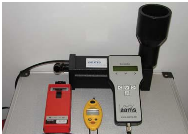
Slika 9. Uređaj AAMS za mjerenje protoka mlaznica
