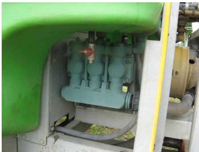
Slika 13. Klipna crpka raspršivača Munckof
