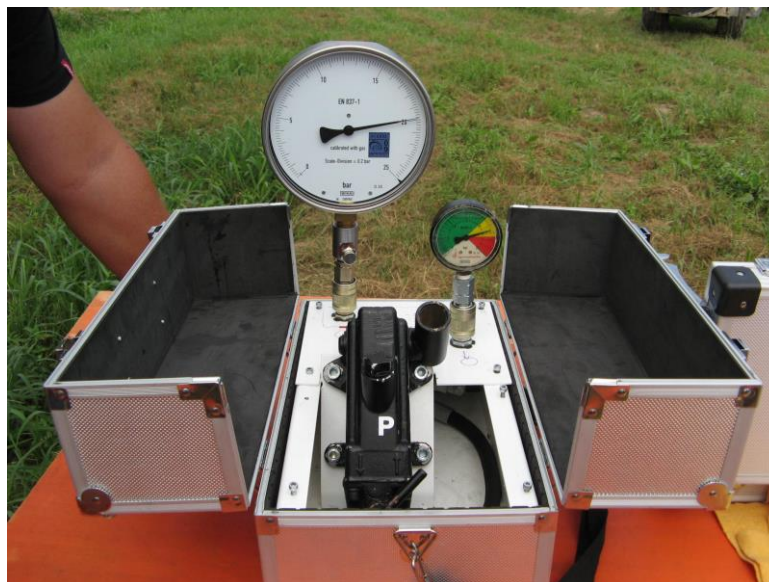
Slika 15. Provjera ispravnosti manometra kod raspršivača Munckof – serijski broj 10502045
