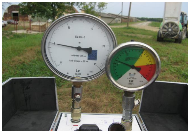
Slika 4. Ispitivanje ispravnosti rada manometara
