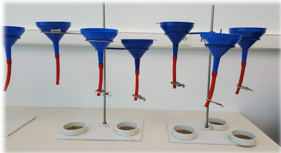
Slika 8. Lijeenci za izdvajanje nematoda Baermannovom metodom
