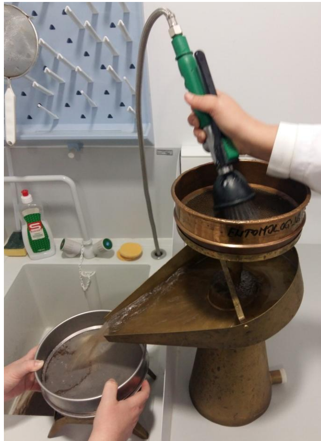
Slika 18. Ispiranje sadržaja sita pod jakim mlazom vode (Izvor: Anja Kolarić)
