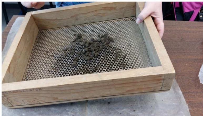
Slika 13. Mrvljenje i propuštanje uzorka kroz sito
