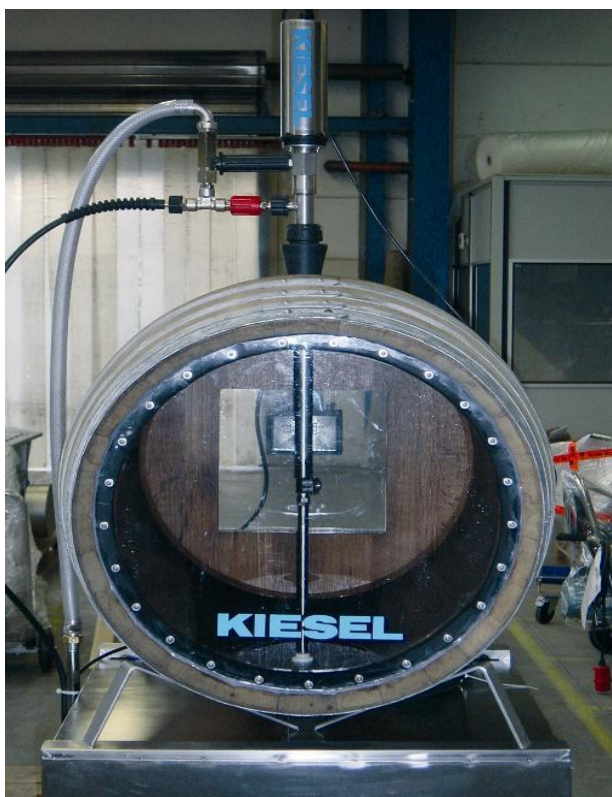
Slika 8: Perač drvenih bačava Njemačke tvrtke Kiesel
