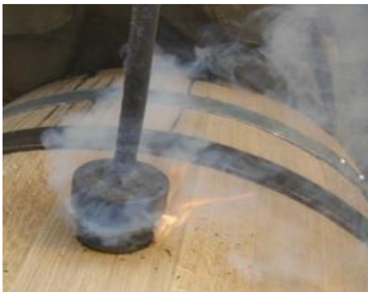
Slika 7: Sumporenje drvene bačve sumpornom trakom
