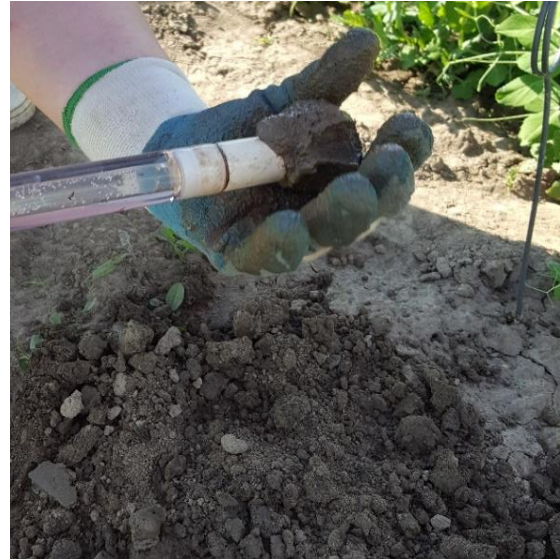
Slika 2. Oblaganje keramičke kapice vlažnim tlom
