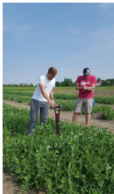
Slika 5. Mjerenje TDR uređajem (fotografija: M. Marković, 2017.)
