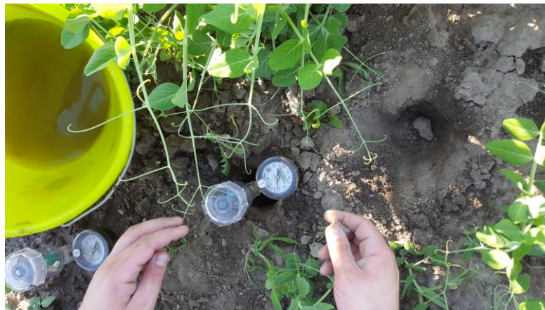
Slika 3. Tenziometri postavljeni u tlo
