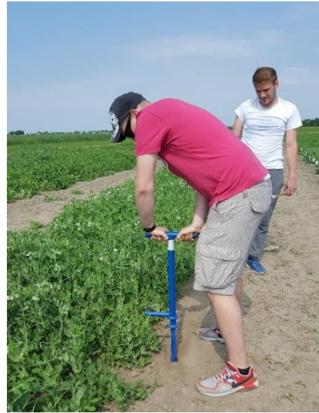
Slika 7. Sondiranje pedološkom sondom (fotografija: M. Marković, 2017.)
