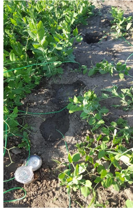
Slika 6. Tenziometar i Watermark uređaji postavljeni u tlo
