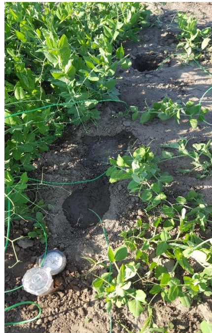
Slika 6. Tenziometar i Watermark uređaji postavljeni u tlo
