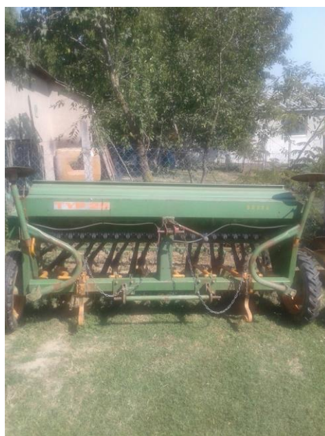
Slika 9: Mehanička sijačica za sjetvu ječma (Izvor: Mario Živković)
