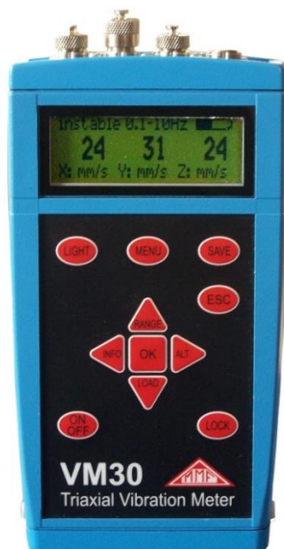
Slika 15. Uređaj za mjerenje vibracija MMF VM30 (URL11)
