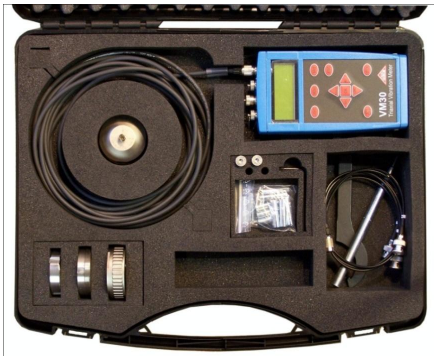
Slika 15. Oprema i uređaj za mjerenje vibracija. (URL)
