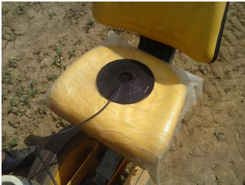
Slika 12. Podloga uređaja za mjerenja vibracija (vlastita fotografija)
