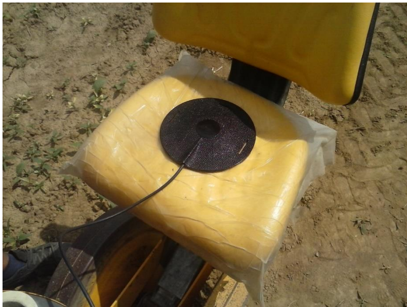
Slika 12. Podloga uređaja za mjerenja vibracija (vlastita fotografija)
