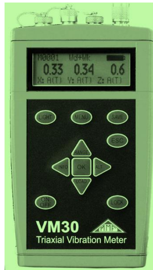
Slika 11. Uređaj za mjerenje vibracija MMF VM30-H (URL6)
