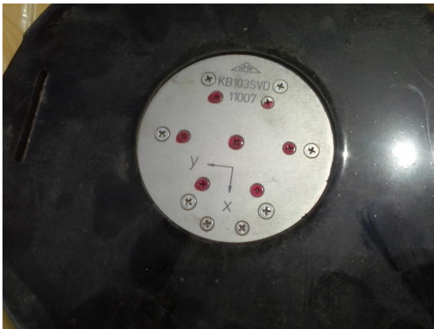
Slika 7. Prikaz pravaca osi koje se mjere (vlastita fotografija)
