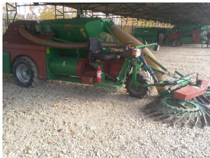
Slika 20. Samohodni stroj za sakupljanje lješnjaka „Facma“
