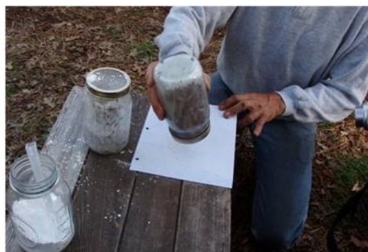
Slika 8. Sipanje uzorka na bijelu podlogu (Izvor: http://scientificbeekeeping.com/fighting-varroa-reconnaissance-mite-sampling/ )
