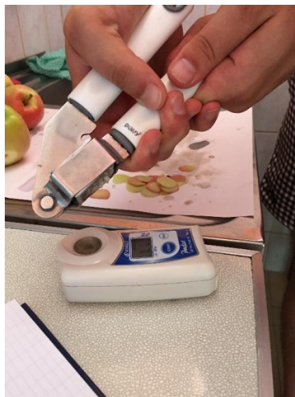
Slika 13. Mjerenje postotka suhe tvari refraktometrom (autor: Đurković, 2015.)
