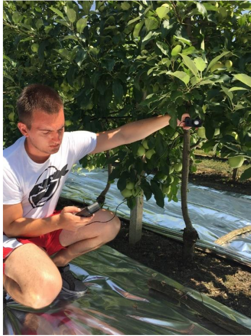
Slika 10. Mjerenje refleksije svjetlosti Lux metrom (autor: Đurković, 2015.)
