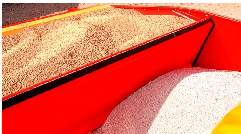
Slika 17. Spremnik sijačice Rapid 400C
