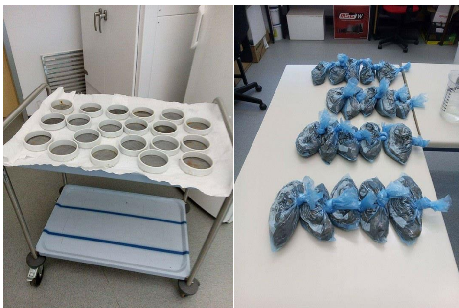
Slike 21. i 22. Uzorak tla u vrećicama i pripremljena sita Foto: Ivana Greganić
