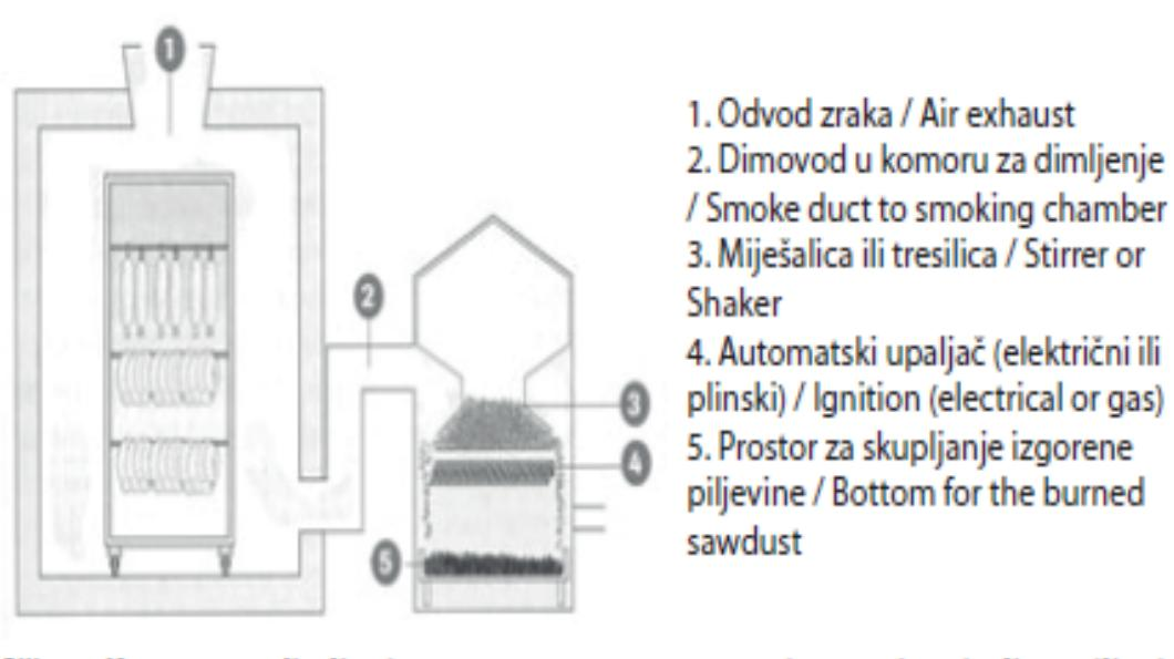
Slika 4. Dimna komora – posredno dimljenje
