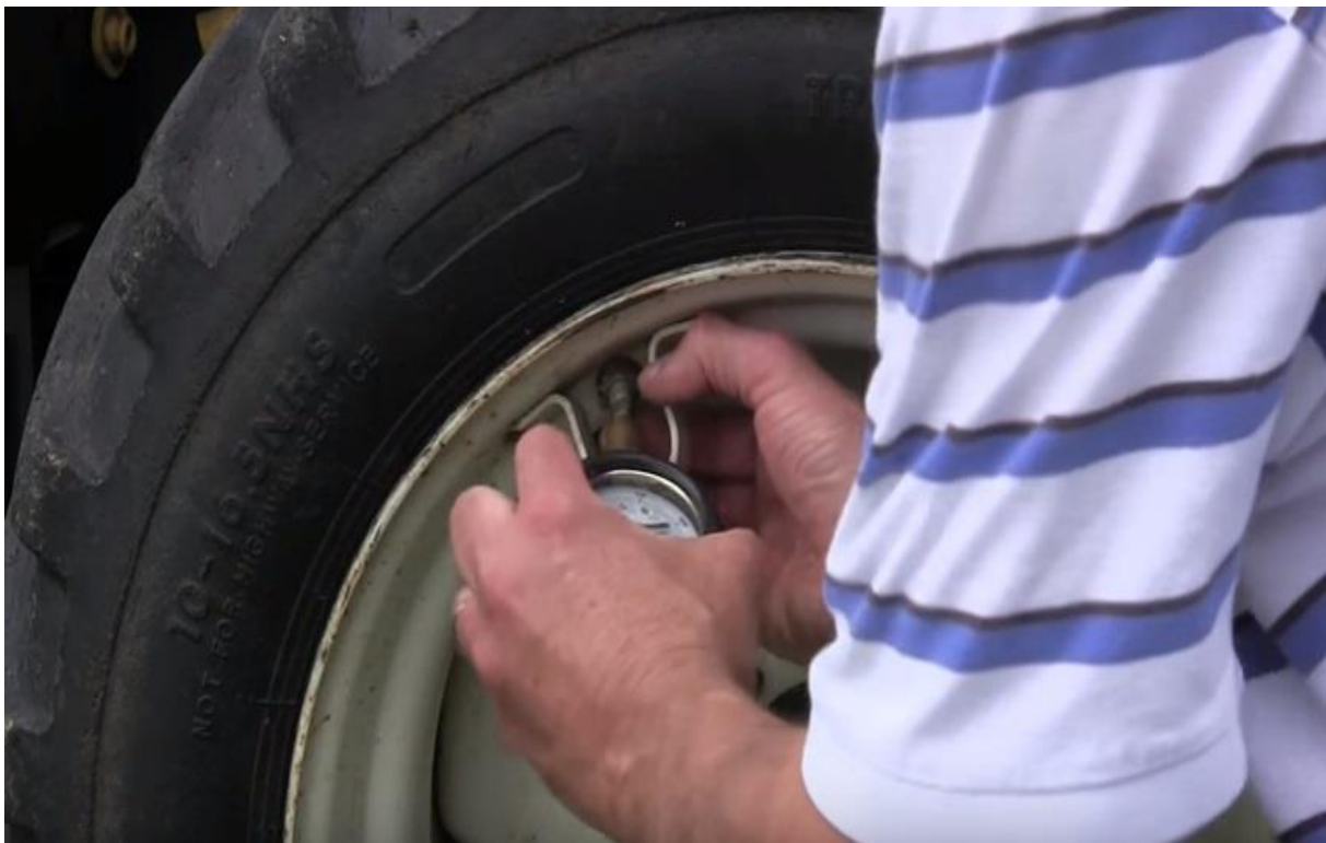
Slika 9. Provjera tlaka u pneumaticima (Izvor: Vlastita fotografija.)
