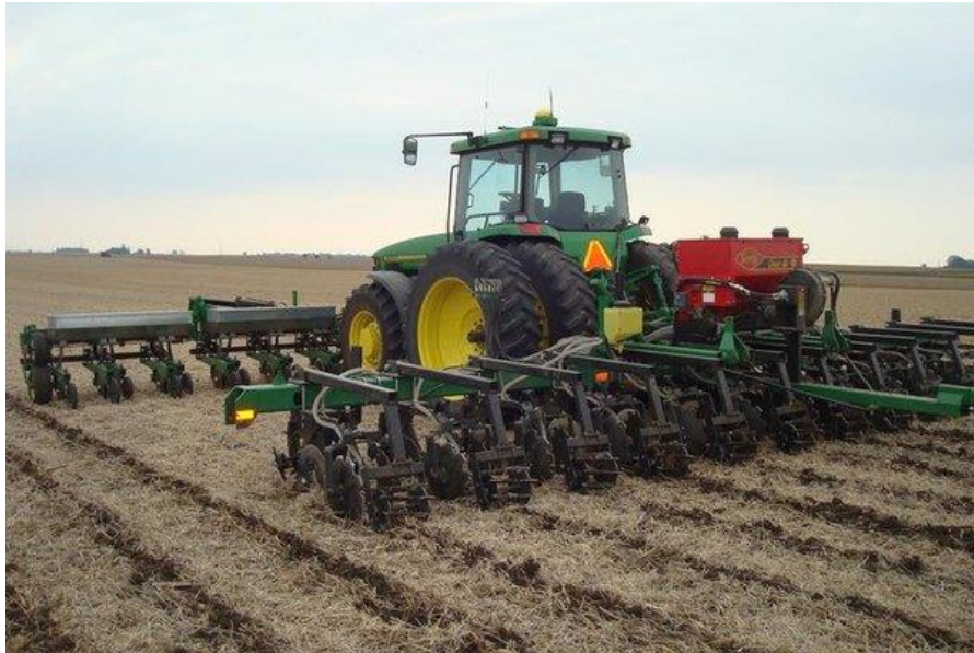
Slika 9. Obrada u trake
