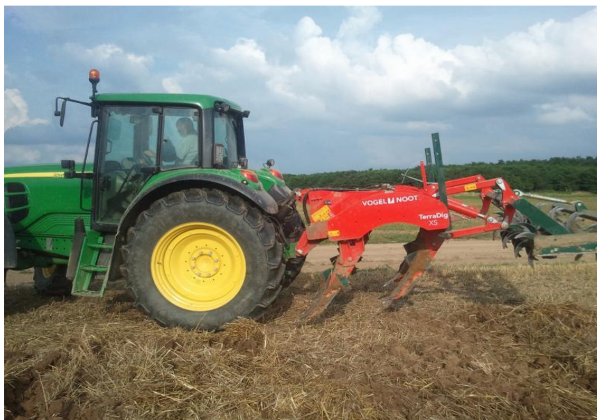
Slika 3: Duboka obrada podrivačem
