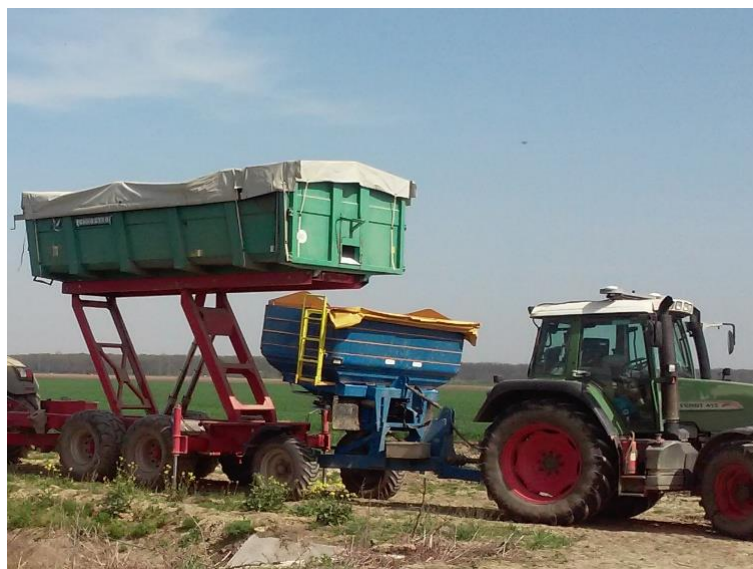
Slika 15. „Bogballe M3W“ centrifugalni rasipač (Izvor: vlastita fotografija)
