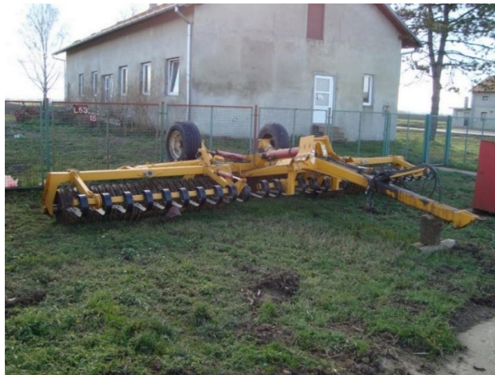
Slika 23. Valjak „Twose HF“ (Izvor: vlastita fotografija)
