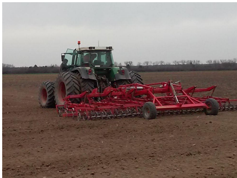
Slika 16. Sjetvospremač „Kongskilde Germinator Sp 7000“ (Izvor: vlastita fotografija)
