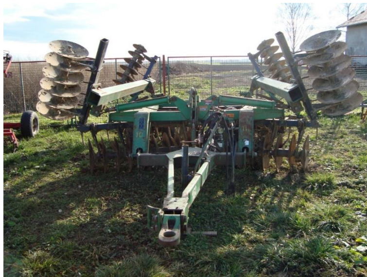
Slika 21. Tanjurača „JD 630“ (Izvor: vlastita fotografija)
