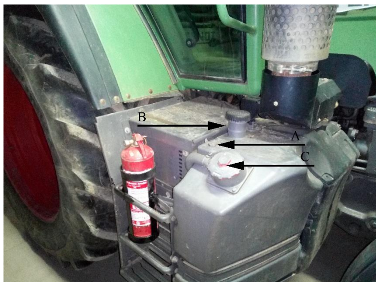
Slika 9. Traktor „Fendt 412 Vario“ A- Mjerač ulja u hidraulici, B- Pročistač ulja, C- Otvor za nadolijevanje ulja u hidrauliku (Izvor: vlastita fotografija)
