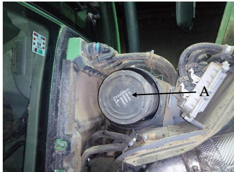
Slika 10. Traktor „Fendt 412 Vario“ A- zračni pročistač
