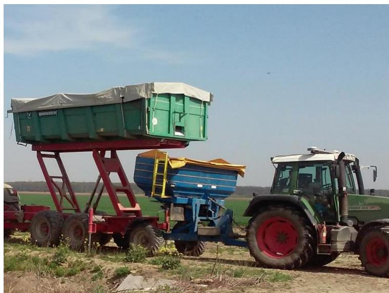
Slika 15. „Bogballe M3W“ centrifugalni rasipač
