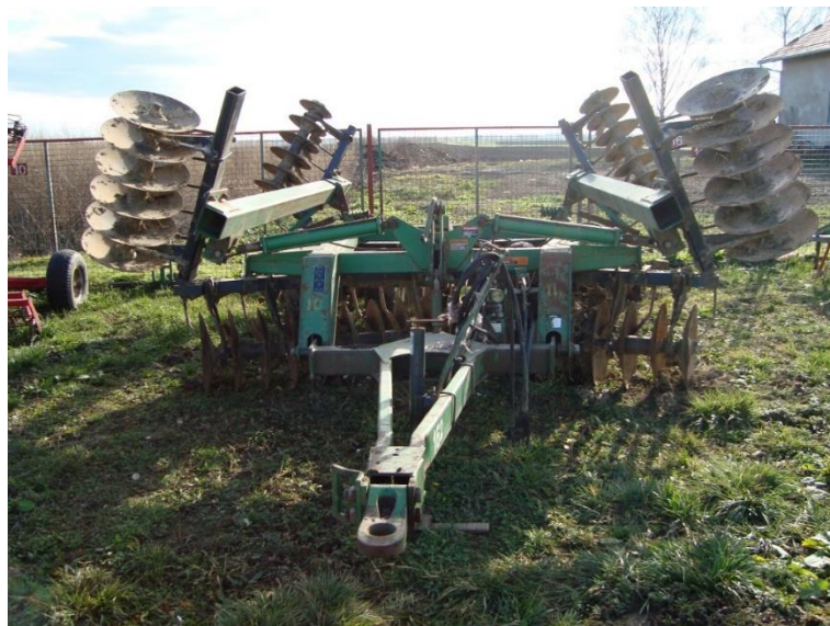
Slika 21. Tanjurača „JD 630“ (Izvor: vlastita fotografija)
