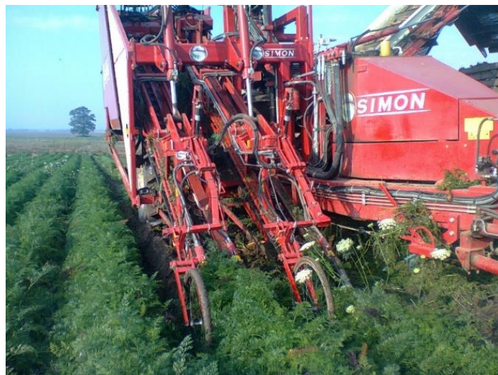
Slika 25. „Simone R2FCMR“ kombajn za mrkvu (Izvor: vlastita fotografija)
