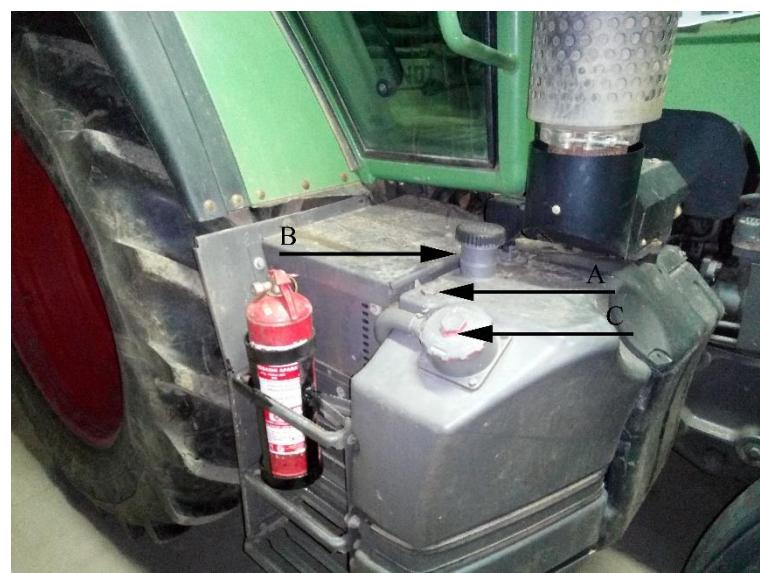
Slika 9. Traktor „Fendt 412 Vario“ A- Mjerač ulja u hidraulici, B- Pročistač ulja,
