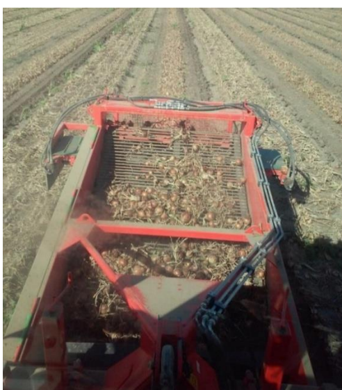
Slika 20. Vadicica „Holares UR135“ (Izvor: vlastita fotografija)
