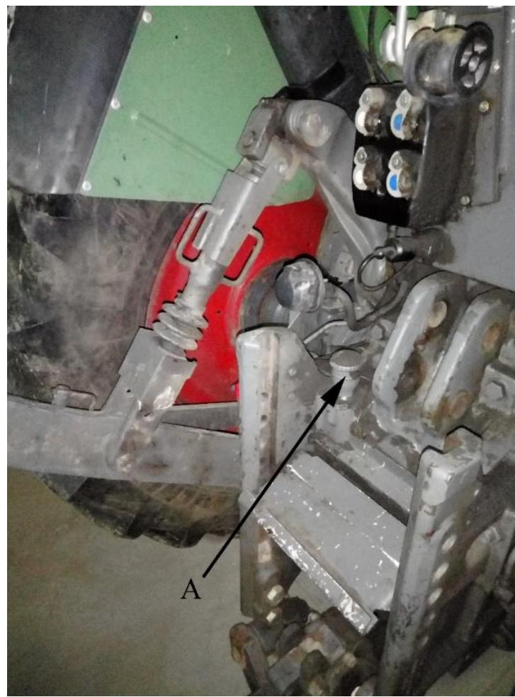
Slika 8. „Fendt 412 Vario“ A - Mjerač ulja u mjenjaču
