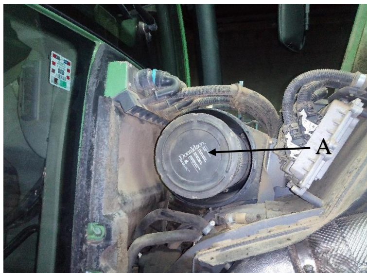
Slika 10. Traktor „Fendt 412 Vario“ A- zračni pročistač (Izvor: vlastita fotografija)
