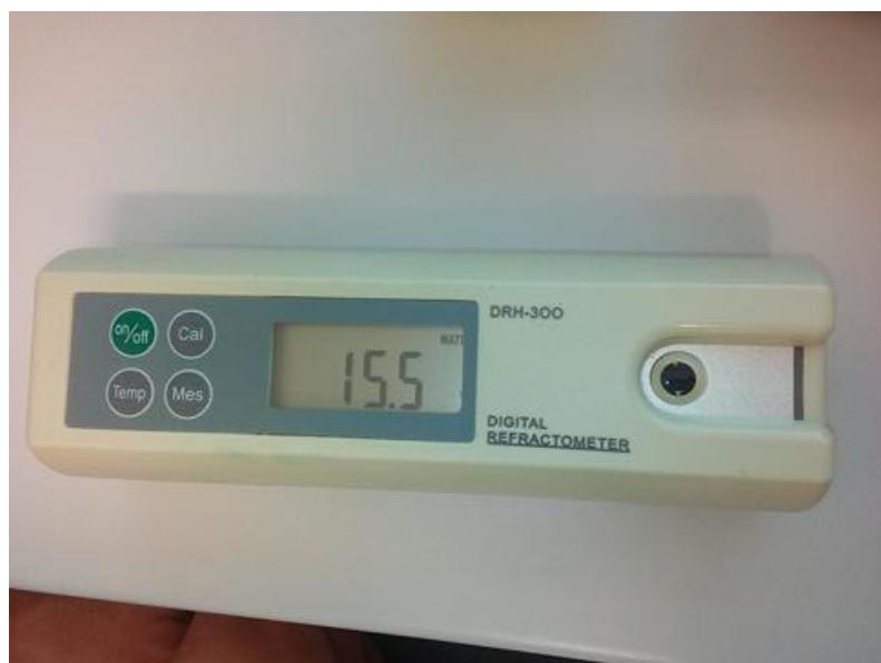
Slika 9. Digitalni refraktometar
